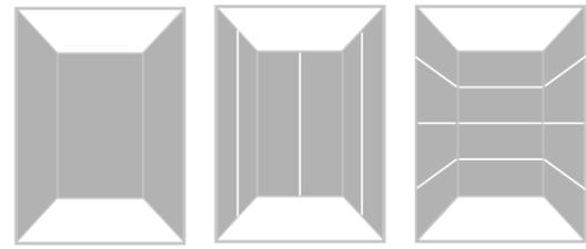
Vertical 1-panel por muro    Vertical 2-paneles por muro    Horizontal 4-paneles por muro
